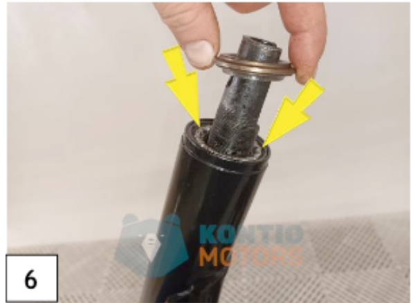
Laita etuhaarukan ylemmän laakerin yläkooli paikalleen. (kuva6)
