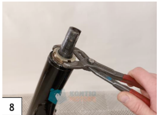
Kiristä ohjauslaakereiden kiristysmutteri sopivalle tiukkuudelle. (kuva8)
