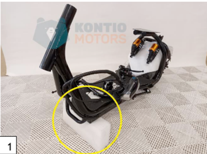
1 Nosta Kruiserin etupää pukin tai muun korokkeen päälle tukevasti. (kuva1)
