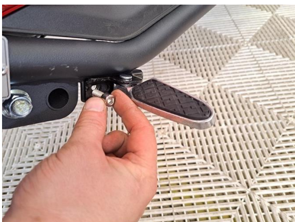
Kiinnitä takajalkatapit kiinnityspulteilla. (kuusiokoloavain 6 mm).
