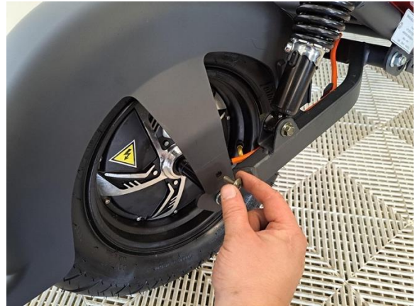
Kiinnitä takalokasuoja kupukantaisillapulteilla (kuusiokoloavain 5 mm).
