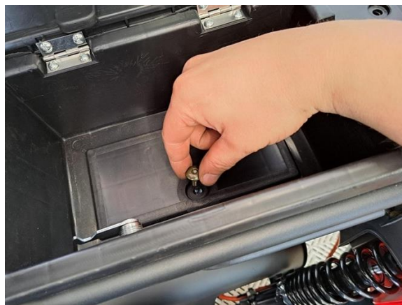
Kiinnitä takaboksi kupukantapulteilla ja kiinnitysmuttereilla. (kuusiokoloavain 5 mm kiintoavain 10 mm).
