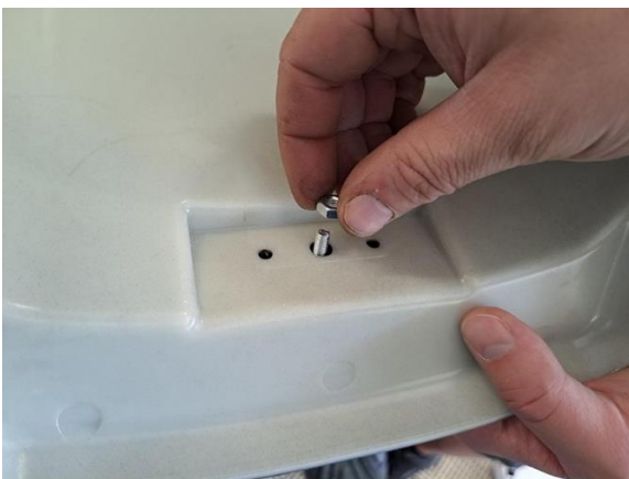
Kiinnitä takaheijastimen mutterilla. (kiintoavain 8 mm).
