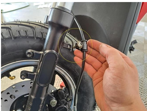
Kiinnitä etujarruletkun pidike kupukantapultilla. (kuusiokoloavain 5 mm).
