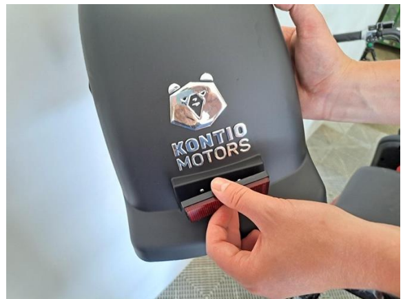
Laita takaheijastin takalokasuojaan kiinni.
