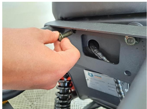
Kiinnitä tarakka kiinnityspulteilla. (kiintoavain 12 mm).
