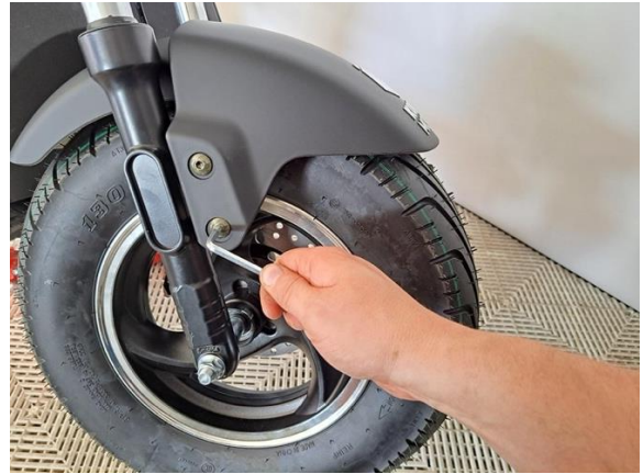
Kiinnitä etulokasuoja kupukantapulteille. (kuusiokoloavain 5 mm).
