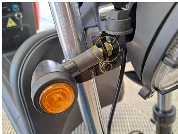
Kiristä etuvilkun kiinnitysmutterit. (kiintoavain 14 mm).
