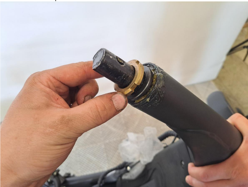
Aseta ohjauslaakereiden kiristysmutteri paikoilleen.
